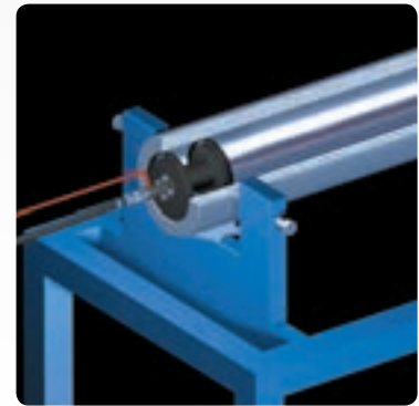
バレル内に設置したアダプタ付き受光器
