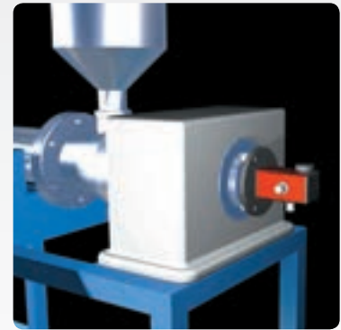
ギアボックススピンドルに設置したレーザー発信器
